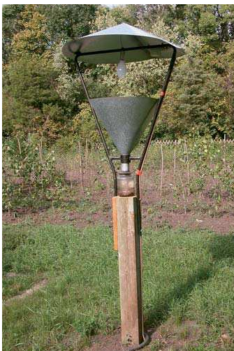
1. ábra. Jermy-féle fénycsapda Püspökladányban (Erdészeti Tudományos Intézet 2010)
