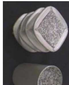
c) Alumínium alkatrész alumínium habbal töltve
