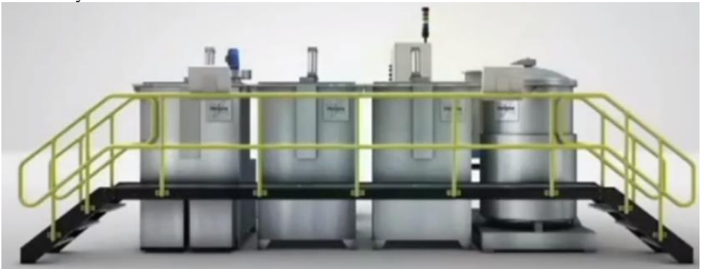
5. ábra Vákuum impregnáló berendezés felépítése [4]
