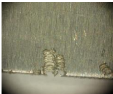
A korrózió haladása 1 nap után Súlyvesztés kontrol: 0,55% Heesztett darab: 3,11%
