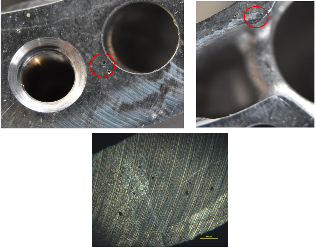
2. ábra Üregek a kompresszor öntvény fedél megmunkált felületén
