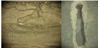
A korrózió haladása 2 nap után Súlyvesztés kontrol: 1,5% Heesztett darab: 4%
