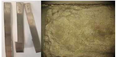
A korrózió haladása 3 nap után Súlyvesztés kontrol: 1,8% Heesztett darab: 5,47%
