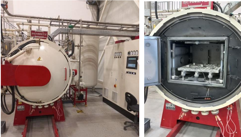
4. ábra Hőkezelő kemence és a próbatestek
