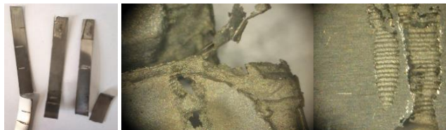
A korrózió haladása 7 nap után Súlyvesztés kontrol: 5,5% Heesztett darab: 6,5%
