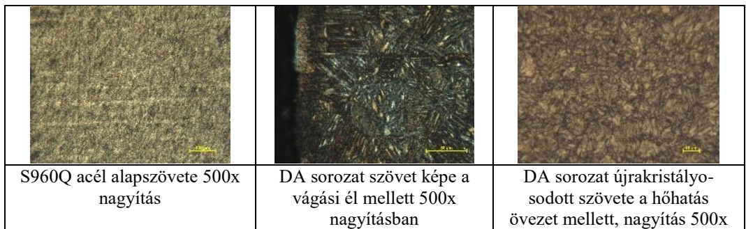
7. Táblázat 960Q acél hőhatásövezetének szövetszerkezete
