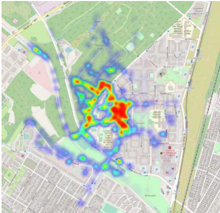
Ábra 8 Mikrotik Gateway RSSI hőterkép
