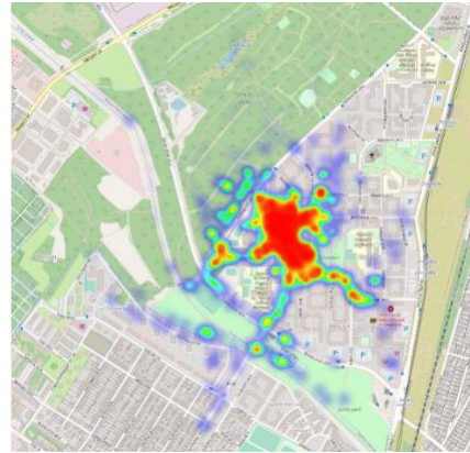
Ábra 9 Tracknet Gateway RSSI hőterkép
