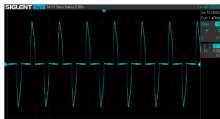
Ábra 3 LED lámpa Áram-idő jelalak
