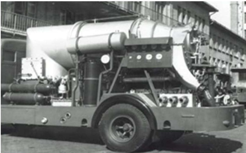
9. ábra: Szilvay-féle gázturbinás szárazoltó [33]
