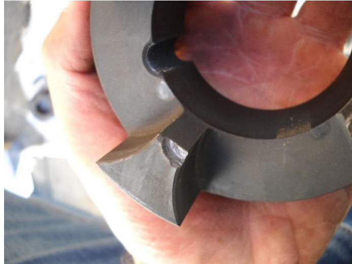
6.5. ábra. Tengelybeállítási hiba okozta tengelykapcsoló sérülés, belső részre eső közeli felvétel.
