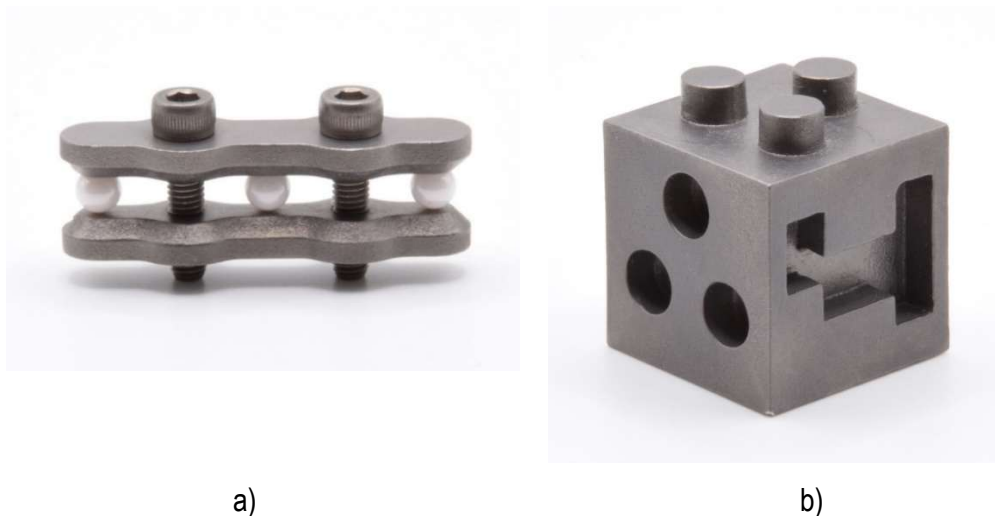
5. ábra: Az elkészült kalibrációs fantom (a) és vizsgálati darab (b)
