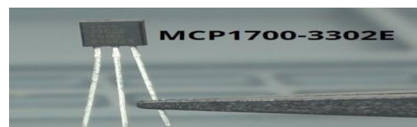
Figure-11. MCP1700-3302E stabilizer
