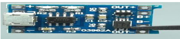
Figure-7. Charging module TP4056
