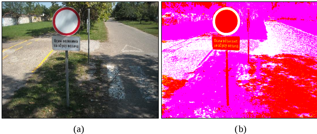
6.24. ábra: A klaszterizáció alkalmazása: (a) bemeneti színes kép, (b) a bemeneti kép L^*a^*b^* színrendszerben
