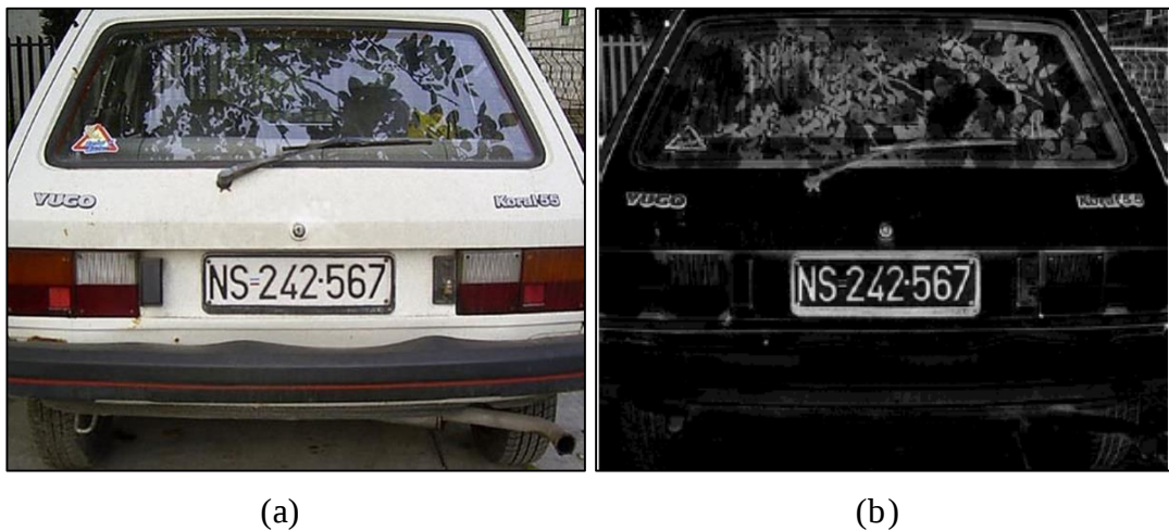
4.12. ábra: A „bottom-hat” transzformáció alkalmazása: (a) bemeneti kép, (b) „bottom-hat” transzformáció hatása
