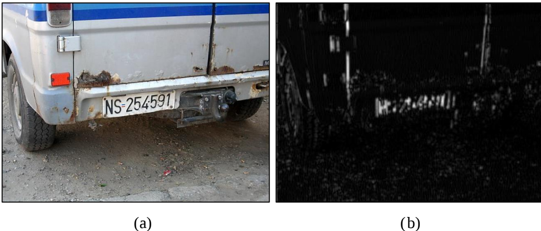
4.14. ábra: A 2D Gabor szűrő alkalmazása textúrák detektálásában: (a) eredeti kép, (b) kiemelt textúrák
