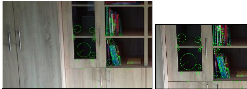
5.15. ábra: A SIFT algoritmus végeredménye: az illesztett, közös pontok a két bemeneti képen
