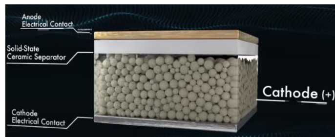
8. ábra: A szilárdtest Li-fém akkumulátor elvi rajza. [8]
