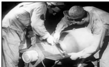
4. ábra Az irányítható farokrész felszerelése
