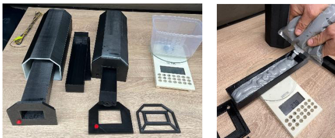
2. ábra Az ARK töltetháza és a MATRA robbanóanyag töltése (a szerzők felvétele)
