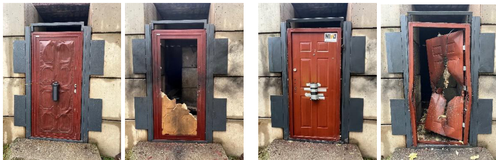
1. ábra ARK-300 és ARK-130 szerelt állapotban és a robbantás eredményei (a szerzők felvétele)
