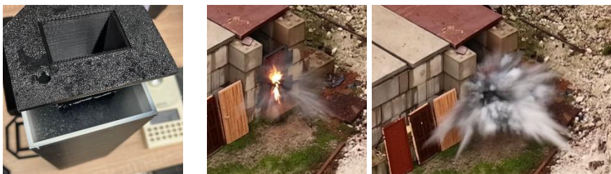
3. ábra A hydrogéllal töltött ARK és a detonáció pillanatai (a szerzők felvétele)
