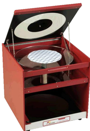
7. ábra A Drape tester és a Webkamerás képet kiértékelő program
