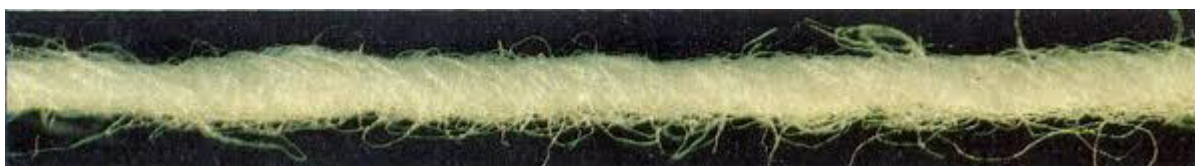
2. Egy átlagos, vágott elemi szálakból álló fonal képe [ http://www.roltex.hu/textilipari_leirasok/fonal ]
