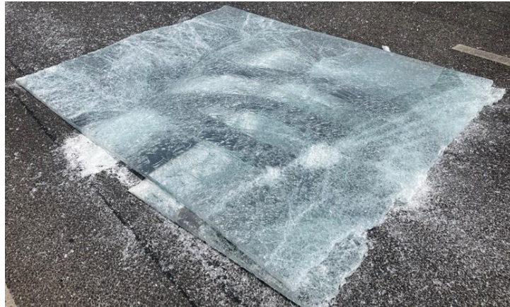
1. ábra: Az üvegtábla lezuhanást követő állapota [Saját kép]
