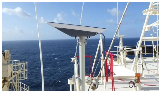
11. ábra: Starlink működésének tesztelése hajón [21]
