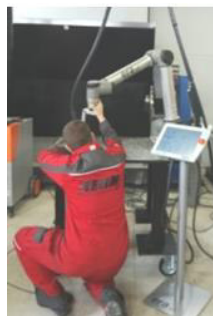
2. ábra - Hegesztő kobot. Forrás: szerző saját felvétele
