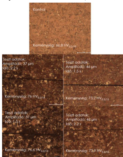
3. ábra - Cu-Cu kötés szövetszerkezete az idő és amplitúdó függvényében
