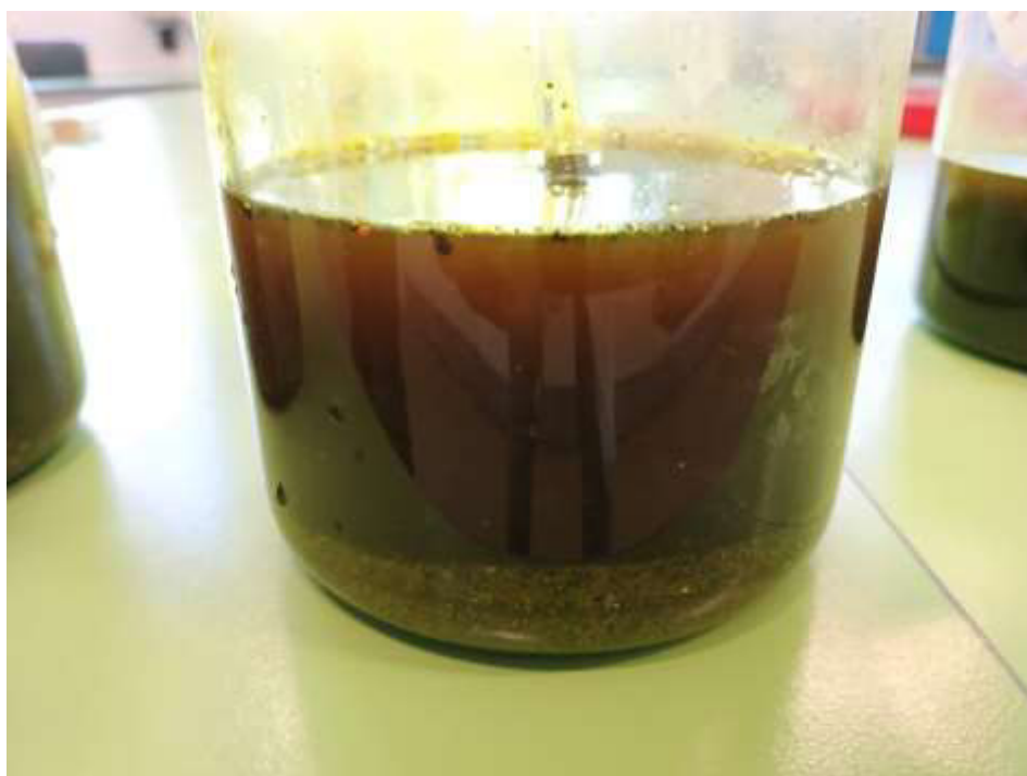
10.kép: Minta ülepítése vasklorid oldatban
