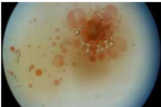
7. ábra: Kénsavban végbemegy a kémiai reakció, eltűnik a „fehér kosz” (Foto: Horváth Katalin)
