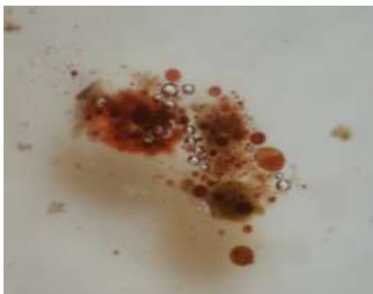
6. ábra: „Fehér kosz” oldódása kénsavban, olajszerű kiválás buborékképződés közben (Foto: Horváth Katalin)
