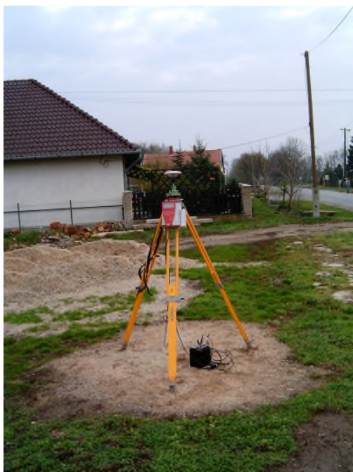
5.1. ábra: A referenciállomás elhelyezése az ideiglenes pontjelen
