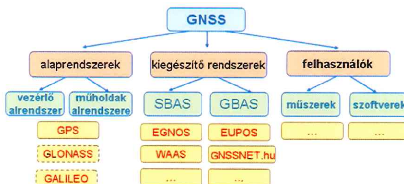
3.1 ábra A GNSS rendszer elemei
