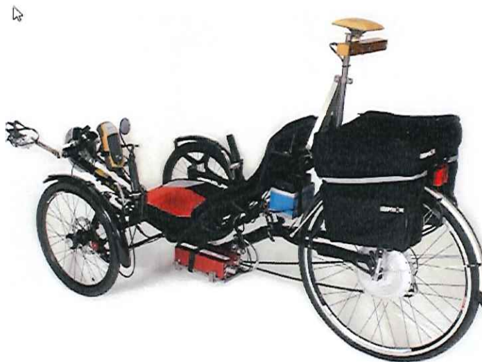
4.2 ábra Geotrike – mobil térinformatikai adatgyűjtő berendezés
