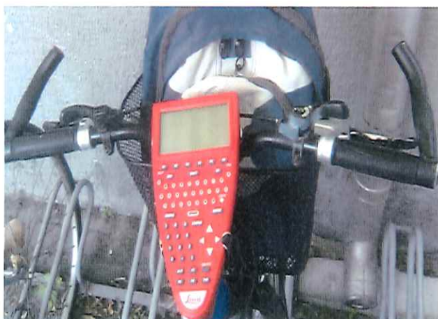
4.1 ábra Kormányszárra erősített controller egység és a felmérés irányítása
