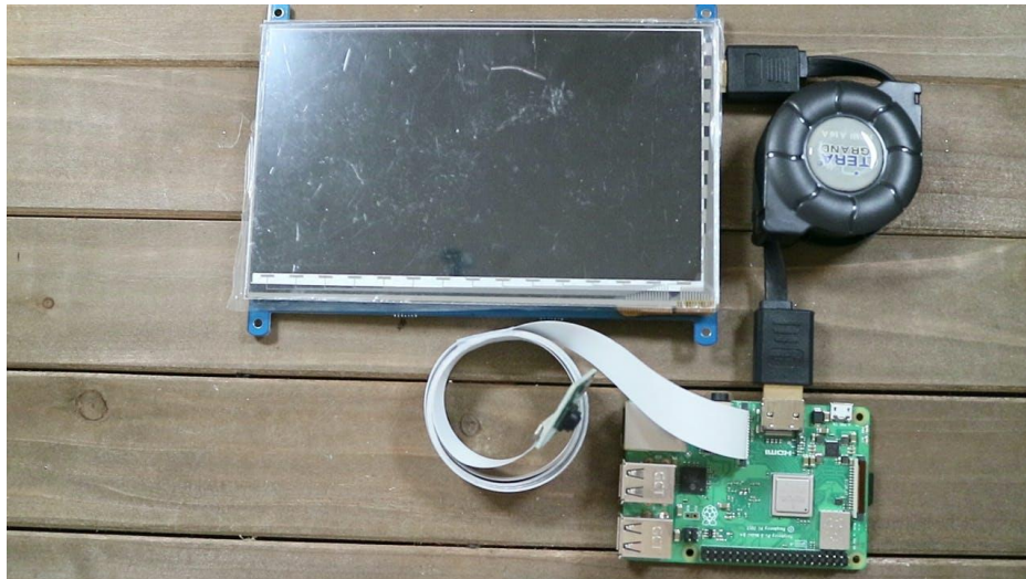
2.2 Ábra: Raspberry Pi, kijelző és kamera
