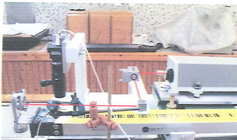
55. ábra Lézerinterferométer és a sugármenete pirossal jelölve
