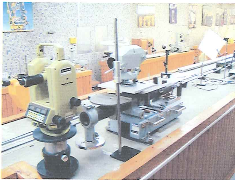
48. ábra A GGKI laboratóriumának libellamérlegén lévő MOM NiA31
