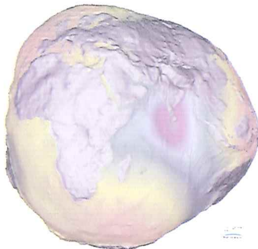
5. ábra A geoid valódi alakja megfelelő torzítással: az undulációk jelentős nagyításával
