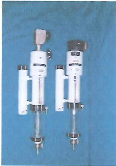
15. ábra Miskolci Egyetemen készített hidrosztatikai szintező
