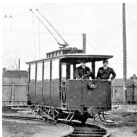
7. ábra: Kandó aszinkron motoros kísérleti kocsija
