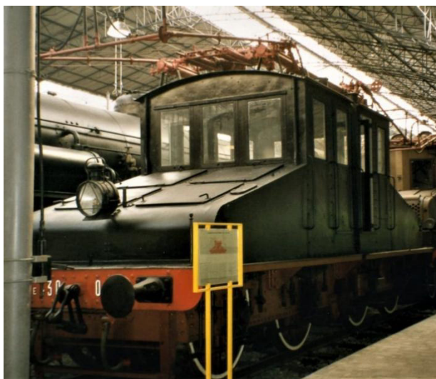
8. ábra: RA 34-es mozdony a milánói Leonardo da Vinci múzeumban, már nem az eredeti, hanem BBC áramszedőkkel felszerelve
