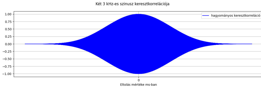
39. ábra: két 3 KHz-es jel keresztkorrelációja
