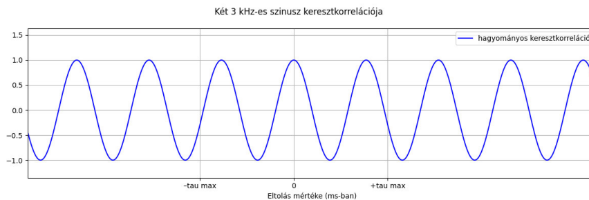
40. ábra: két 3 KHz-es jel keresztkorrelációja kinagyítva
