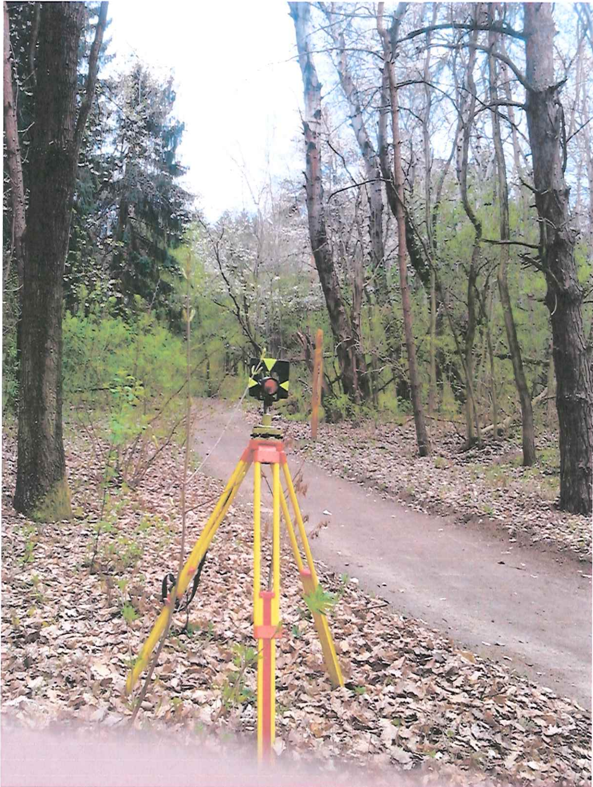
6.1 ábra: Kényszerközpontosan elhelyezett prizma
