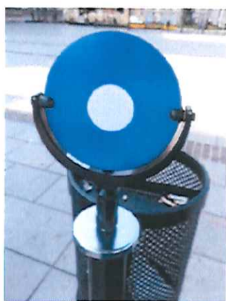
4.14. ábra: Reflektor, prizma, kapcsolópont
