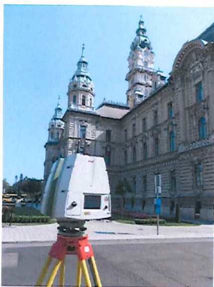
4.17. ábra: A győri városháza lézerszkenneres mérése
