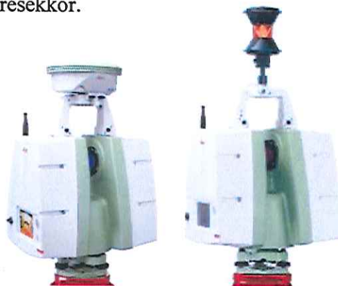
4.16. ábra: A Leica GNSS SmartAntenna és a központos prizmatartó [Váradi, 2010]
