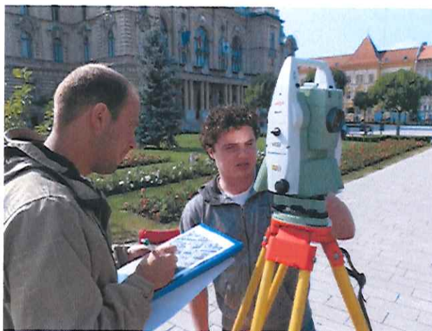
4.13. ábra: A sokszögvonat kezdőpontján történő mérés
