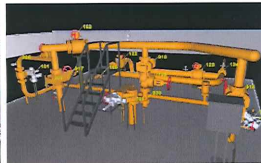
2.10. ábra: Csőhálózat pontfelhője és háromdimenziós modellje (forrás: http://www.laserscan.hu/i/ SourceImage/gepeszet.pdf )
