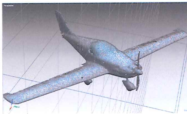
2.16. ábra: Lézerszkennelt repülőgép (forrás: http://www.laserscan.hu/i/SourceImage/LaserScan_hun.pdf )
