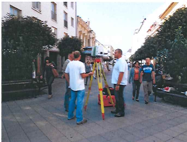
4.20. ábra: Lézerszkenneres mérés a sétálóutcában
