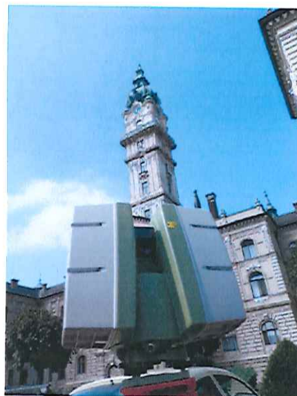
4.17. ábra: A győri városháza lézerszkenneres mérése
