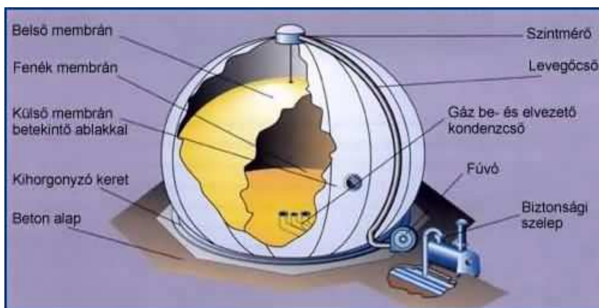
13. sz. ábra: Biogáz tartály felépítése (20. Forrás: http://www.okotechnik.hu/sattler.html )
