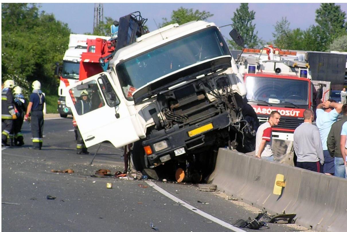
46. ábra Tehergépjármű Deltabloc betonfallal ütközés után 2007-ben (forrás: Magyar Közút)
