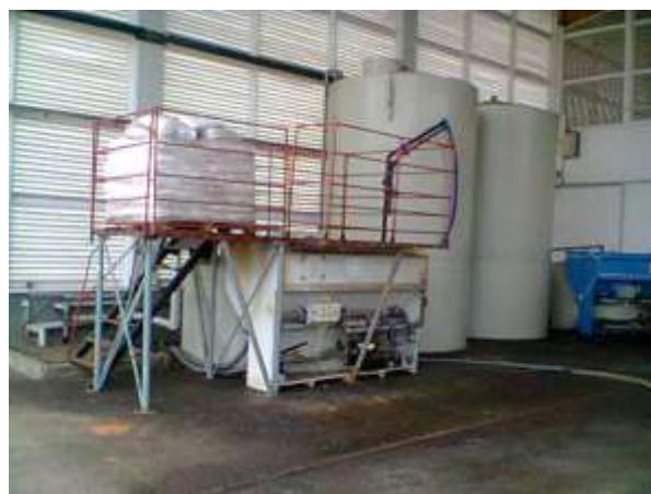
21. kép: \text{CaCl}_2 oldatkeverő berendezés
