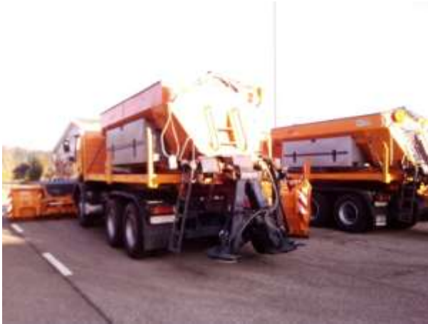
24. kép: Homlokekével felszerelt sószóró
