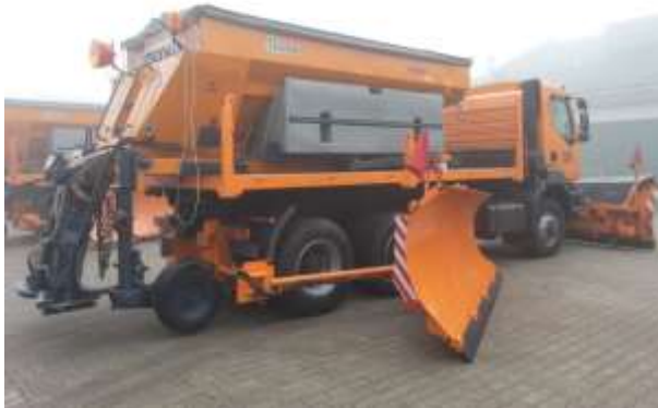
59 kép: Oldal- és homlokekével felszerelt sószóró
