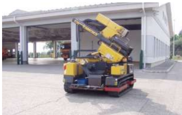
46. kép: ORTECO típusú korlát láb leverő-kihúzó célgép
