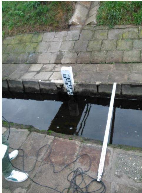
11.ábra Mélységmérési pontok helyzetének meghatározása szondarúddal
