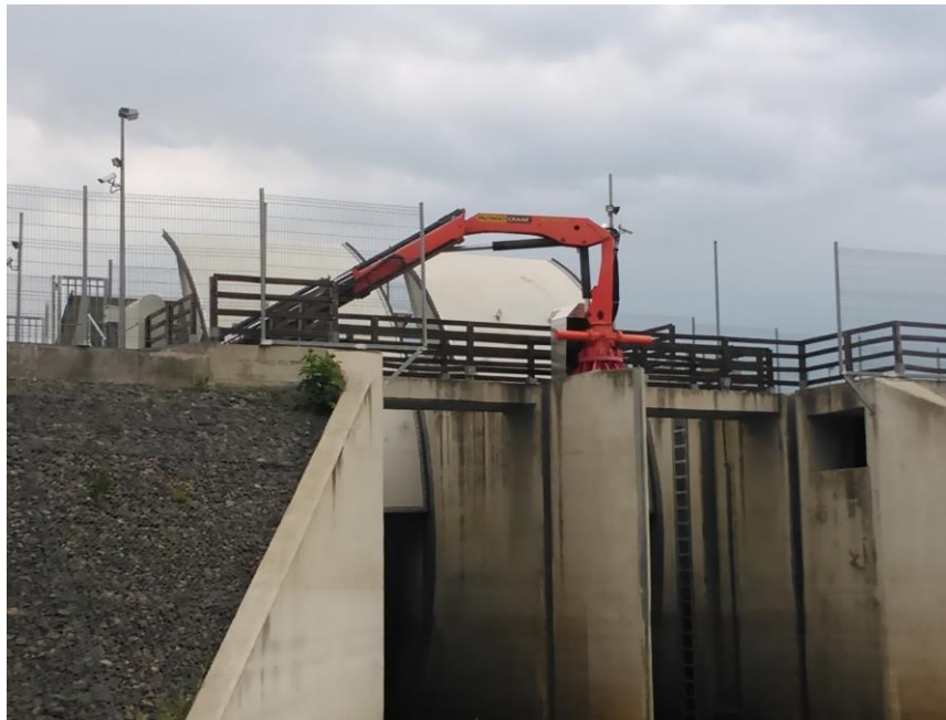
9.ábra Forgódarus emelőberendezés
