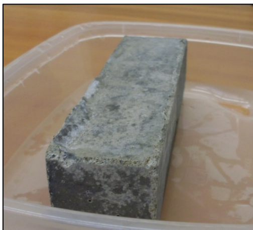
23. kép A C-TECH medence szelektorterében 3 hónapig tárolt betonhasáb
