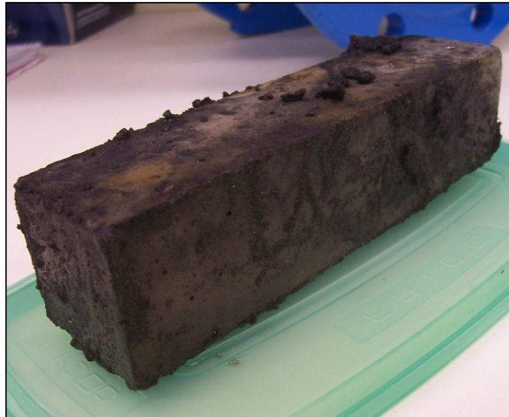
28. kép A C-TECH medence főreaktor terében 12 hónapig tárolt betontest felületén megtapadt iszapszemcsék
