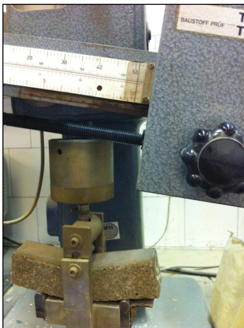
6. kép Húzó-hajlító szilárdsági vizsgálat menete
