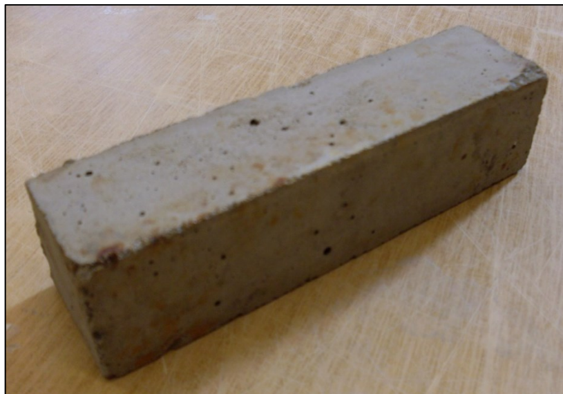
29. kép A C-TECH medence főreaktor terében 12 hónapig tárolt betonhasáb megtisztított felülete
