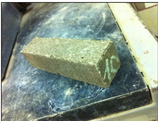
8. kép Az átemelő medencében 3 hónapig tárolt betonhasáb
