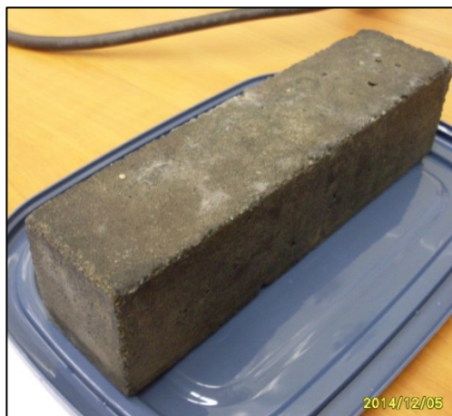
24. kép A C-TECH medence szelektorterében 6 hónapig tárolt betonhasáb
