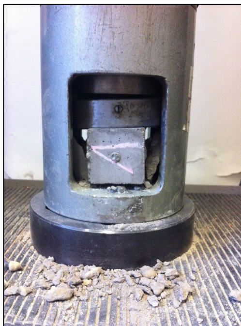
7. kép Nyomószilárdsági vizsgálat menete
