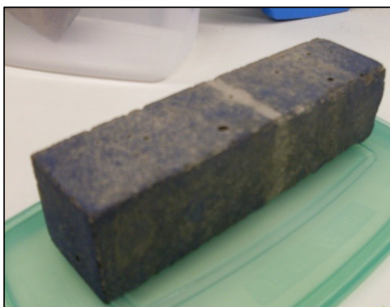
25. kép A C-TECH medence szelektorterében 9 hónapig tárolt betonhasáb
