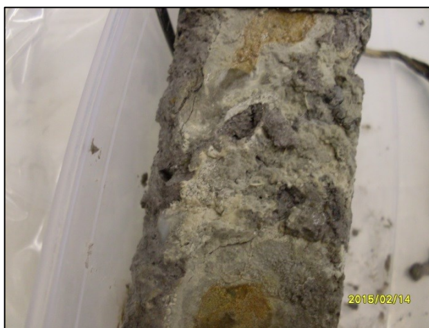
17. kép A UASB reaktorban 6 hónapig tárolt betonhasáb felületén kialakult gél állagú réteg
