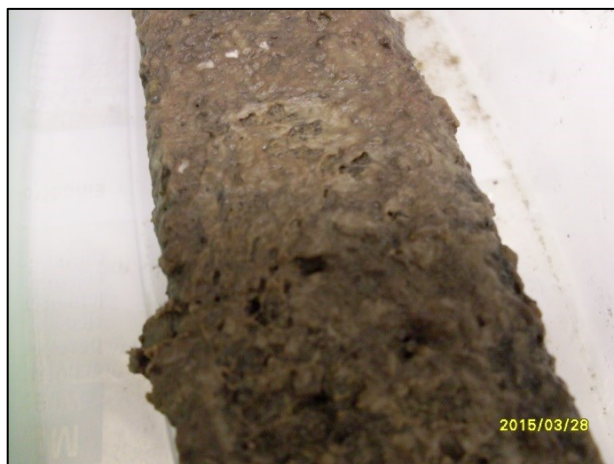
34. kép A kiegyenlítő medencében 12 hónapig tárolt betonhasáb felületén kialakult biofilm
