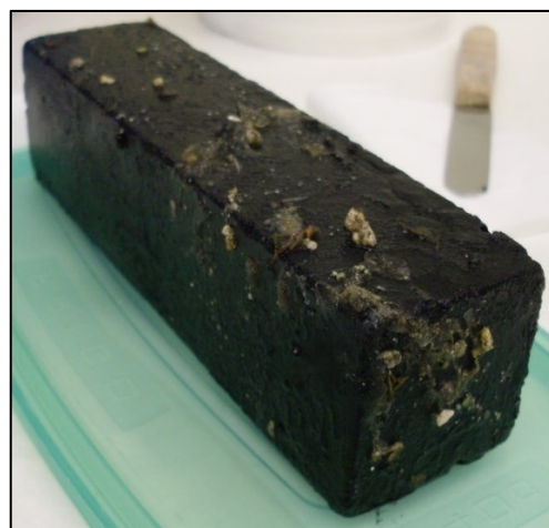
37. kép A homokfogó műtárgyban 12 hónapig tárolt betonhasáb felülete
