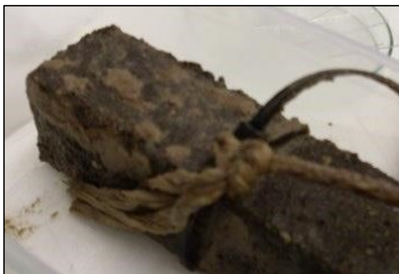
33. kép A kiegyenlítő medencében 3 hónapig tárolt betonhasáb felületén kialakult biofilm
