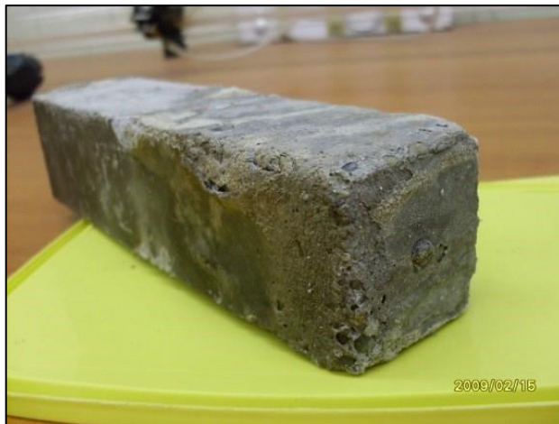
16. kép Az UASB reaktorban 3 hónapig tárolt betonhasáb felülete
