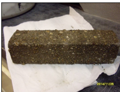
10. kép Az átemelő medencében 9 hónapig tárolt betonhasáb
