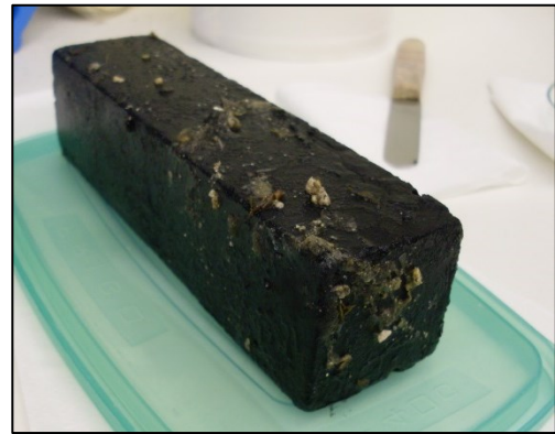
22. kép A homokfogó műtárgyban 12 hónapig tárolt betonhasáb
