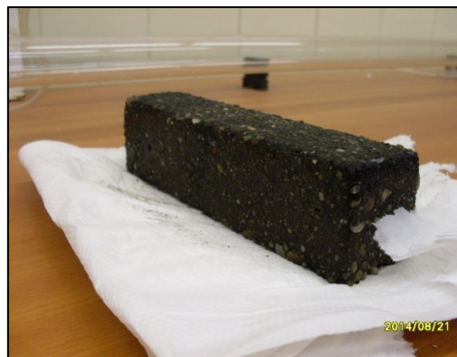
9. kép Az átemelő medencében 6 hónapig tárolt betonhasáb
