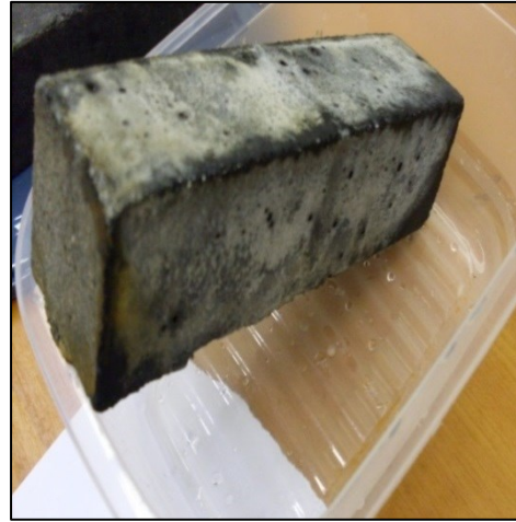
20. kép A homokfogó műtárgyban 6 hónapig tárolt betonhasáb
