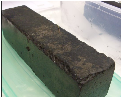
21. kép A homokfogó műtárgyban 9 hónapig tárolt betonhasáb
