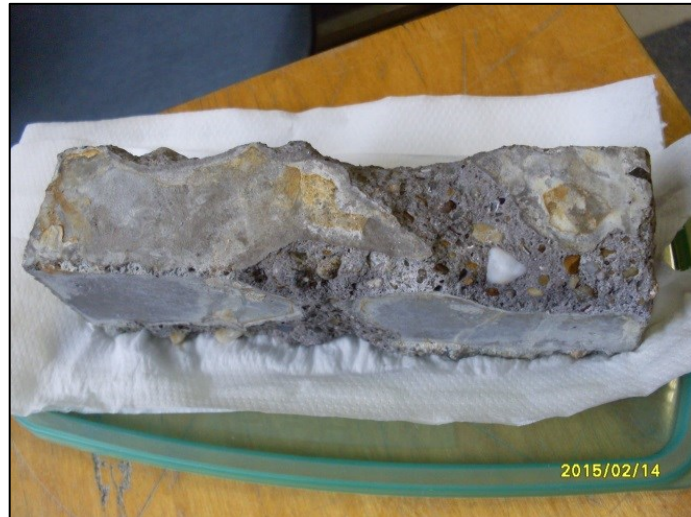
18. kép AZ UASB reaktorban 6 hónapig tárolt betonhasáb megtisztított felülete
