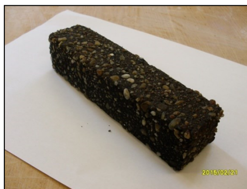
11. kép Az átemelő medencében 12 hónapig tárolt betonhasáb
