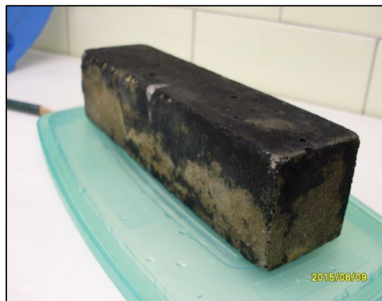
26. kép A C-TECH medence szelektorterében 12 hónapig tárolt betonhasáb
