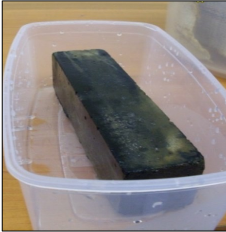
19. kép A homokfogó műtárgyban 3 hónapig tárolt betonhasáb
