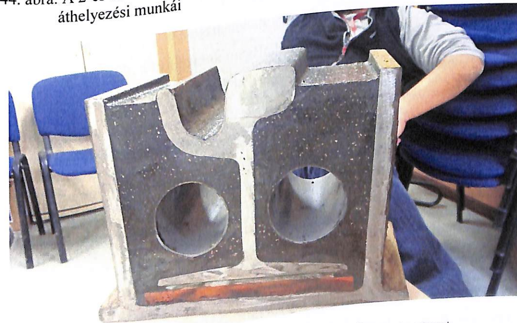
46. ábra. Edilon rendszerű pályaszerkezet, keresztmetszet
