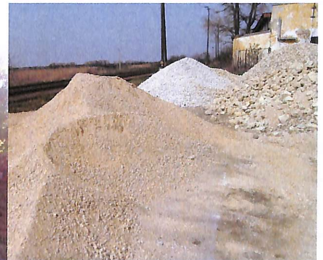
11. ábra Zúzottkő depózása
