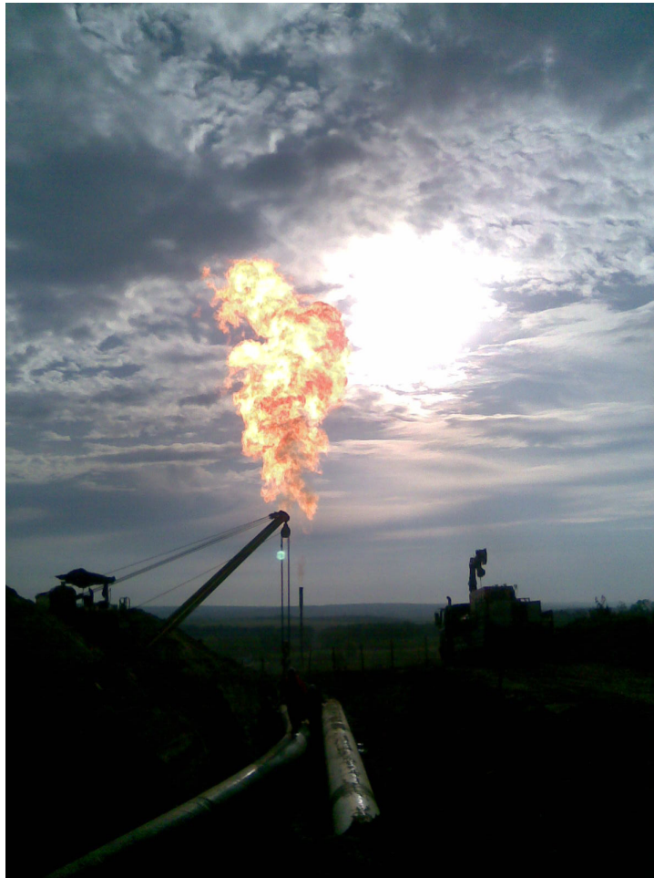
45.kép DN800 PN63 vezetékhez csatlakoztatott DN300 méretű fáklya A 10m magas vezeték eltörpül a láng magasságához képest Forrás: Szűcs László, 2009
