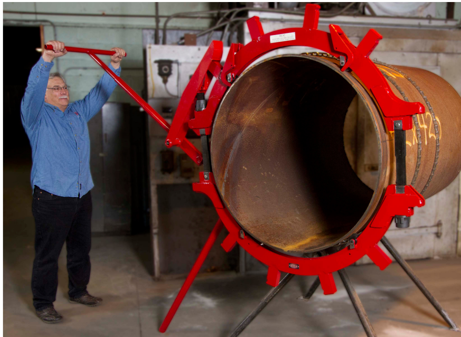
47.kép Szikramentes vágás bemutatása kézi berendezéssel, DN800 méretben Forrás: www.reedmfgco.com
