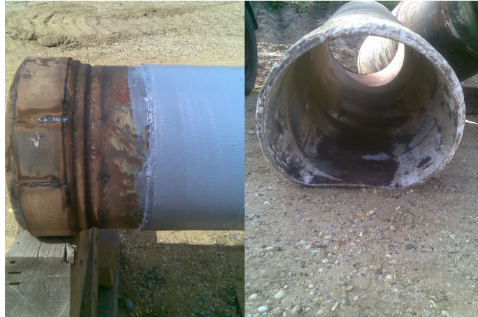
54.kép Kifelé vágó vágóél – Helyben készített rögtönzött megoldás a csőből vágott „karikák” felhasználásával, bal oldalon eredeti állapotban, jobb oldalon behorpadva Forrás: Szűcs László, 2009
