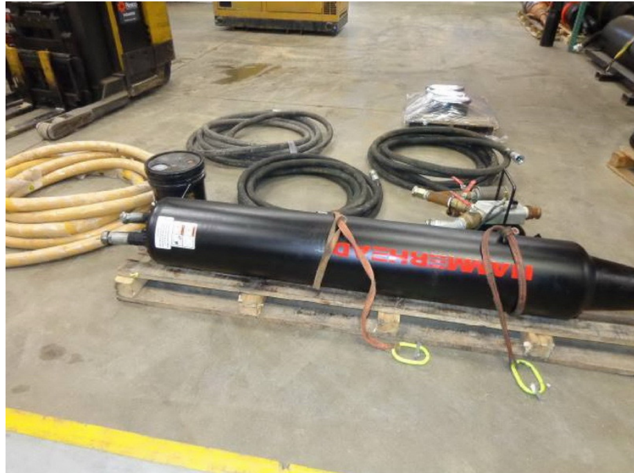
31.kép 16"Hammerhead Mole – 400mm-es sajtoló rakéta és a szükséges alkatrészek: tároló keret, levegő tömlők, olajozó állomás és olaj Forrás: www.hammerhaedtrenchless.com
