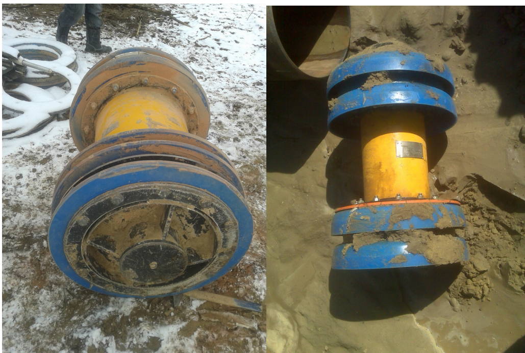
34.kép KÖOP gyártmányú csőgörények használat után. Balra DN800 méretben két irányba járatható egyenes gumikkal szerelve, jobbra DN450 méretben egy irányba járatható szoknyás gumikkal szerelve Forrás: Szűcs László, 2014
