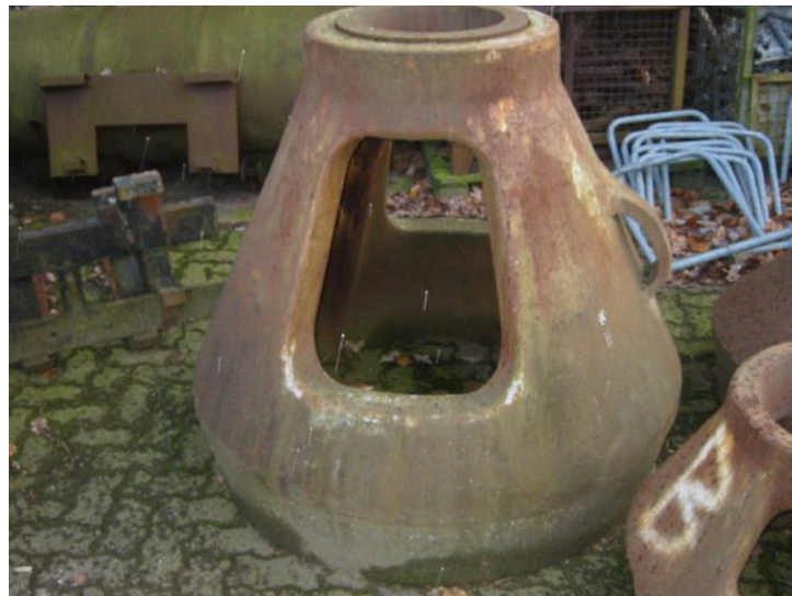
30.kép DN1000 méretű csőbe illeszkedő földkidobó kúp Forrás: www.tracto-technik.de
