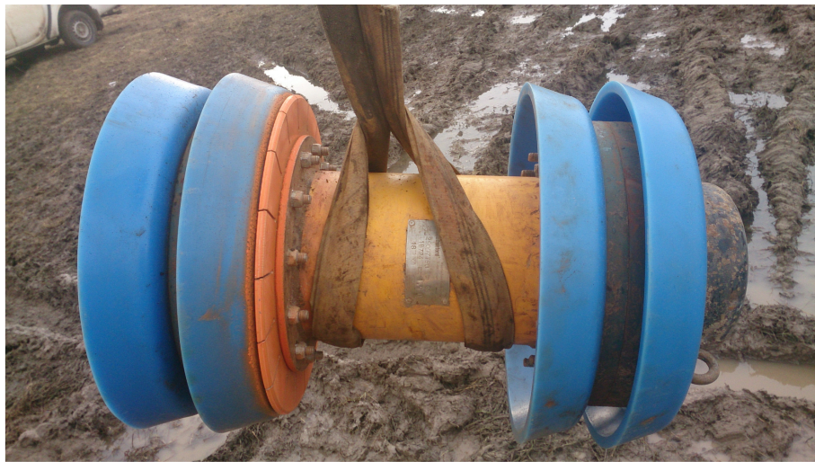
43.kép Alumínium kalibráló tárcsával szerelt DN450 görény Forrás: Dénes Pál, 2014
