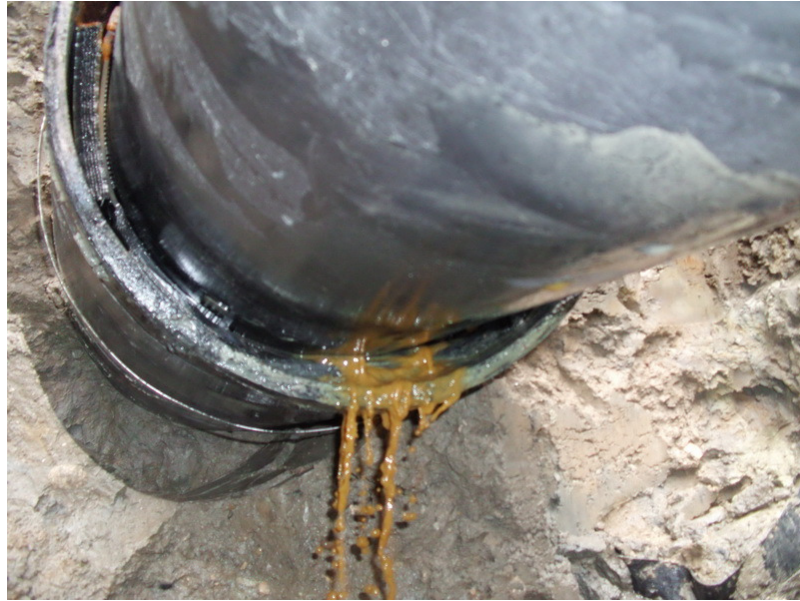
16.kép Diagnosztikai céllal feltárt védőcső, gumiharang lebontását követően Forrás: Szűcs László, 2011
