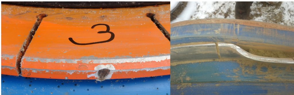
44.kép Sérült kalibráló tárcsák: balra éles bemaródás, jobbra durva elhajlás Forrás: Dénes Pál, 2014
