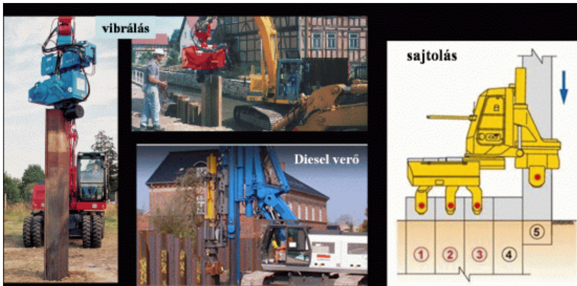
37. ábra: A szádpallók lehajtásának a módszerei
