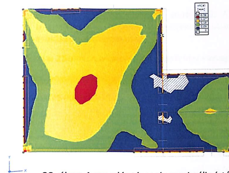
28. ábra: A repedés tágasság maximális értéke: 0,36 mm.
