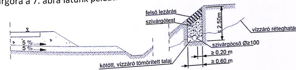
7. ábra Megszakító övszivárgó felépítése
