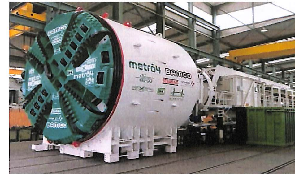
11. ábra: A 4-es metró egyik fúrópajzs a gyári átvételkor
