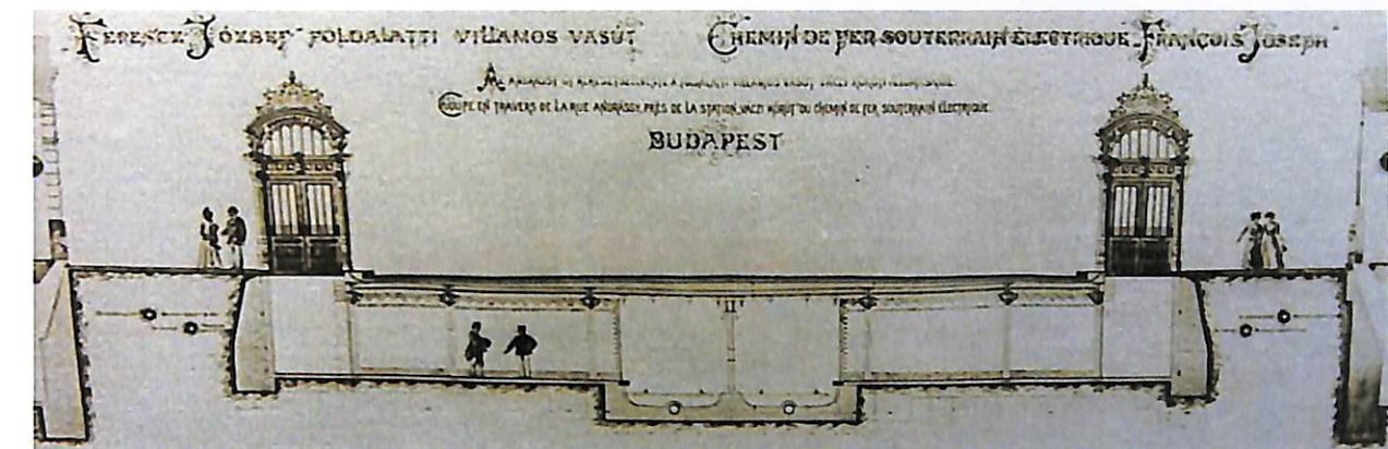
15. ábra: A Millenniumi Földalatti Vasút állomási keresztmetszévénye
