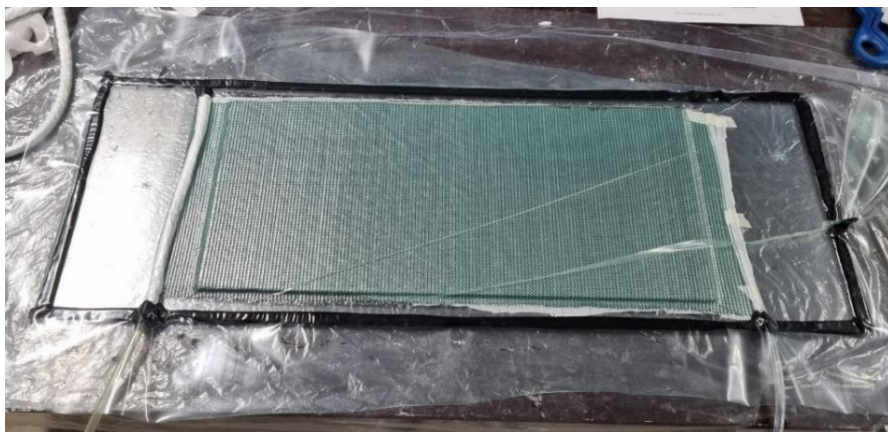
6.4. ábra: Vákuumos formázás végeredménye [saját kép]
