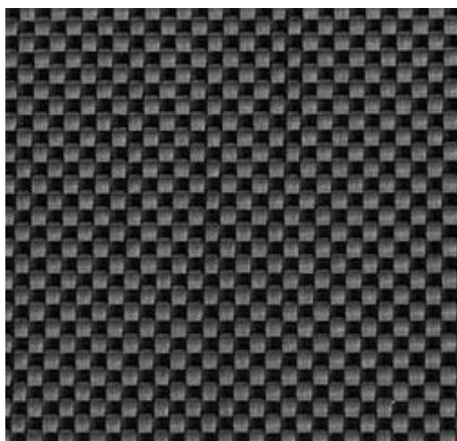
3.4. ábra: Zsákszövés mintájú szénszál. Szénszál II.-III. [21]
