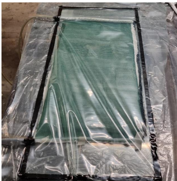
6.3. ábra: Vákuumos formázás a fólia felhelyezése után [saját kép]
