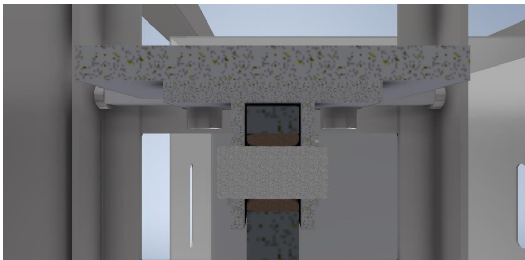
20.ábra: Préslap és a nyomókar kapcsolata
