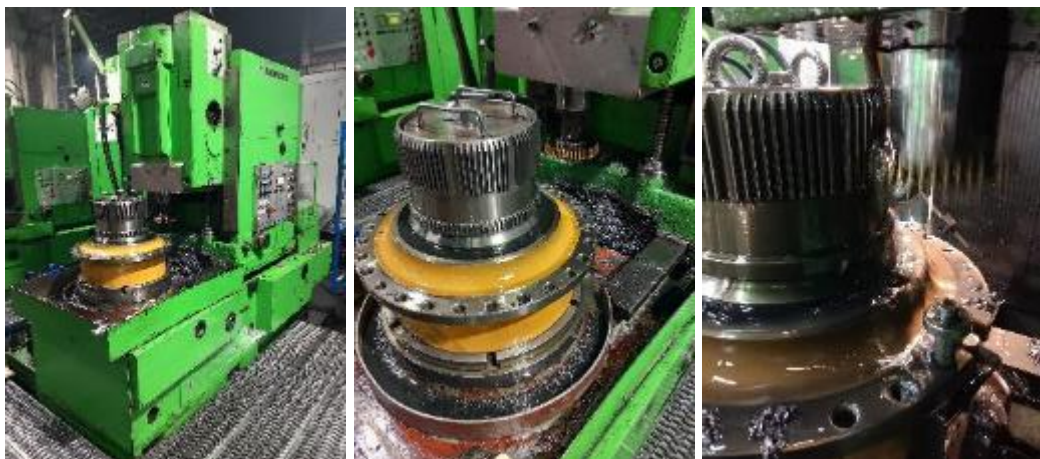
17.ábra Toscelakovice OHA-50-A – Fogaskerék gyártógép
