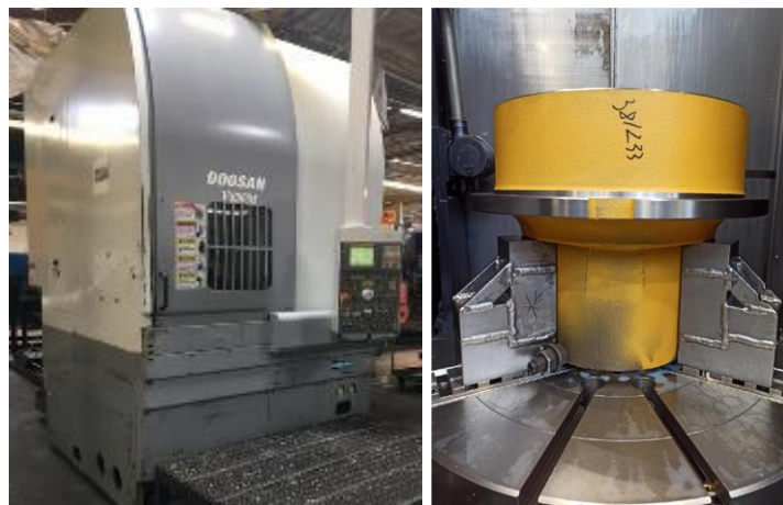
12.ábra Doosan V850M függőleges eszterga (és munkatere)
