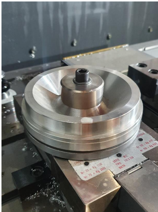
7.3. ábra: Az előgyártmány megfogása marógépben
