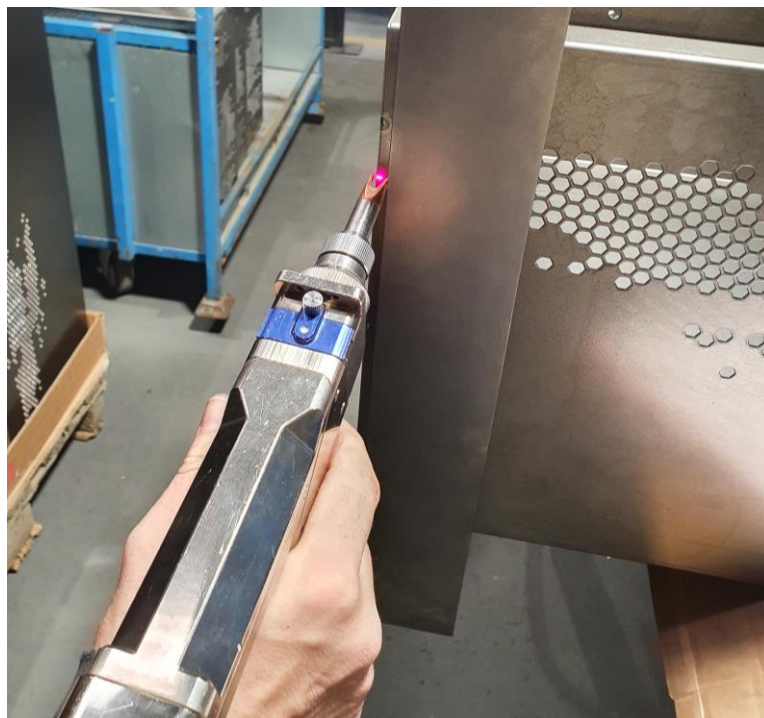
42. ábra Megvezető készülék és lézer hegesztőpisztoly egymáshoz viszonyított helyzete [saját]
