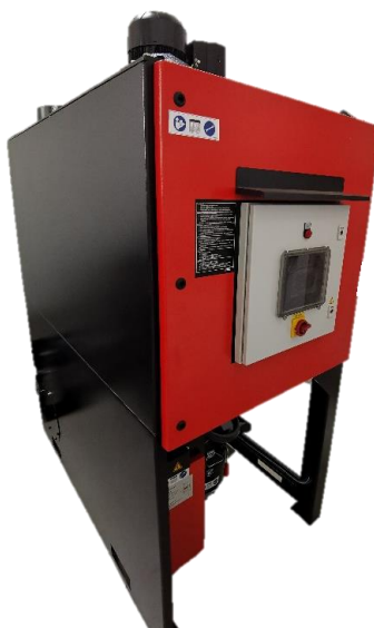
23. ábra Herding COMP 1500 9/9 SB típusú porszűrőegység [saját]
