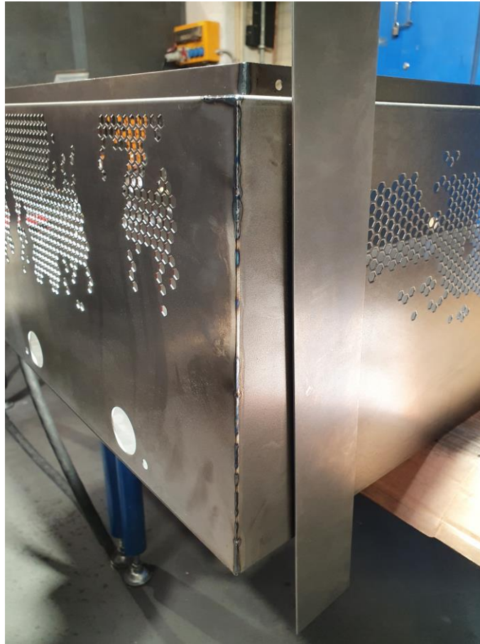
43. ábra Kézi lézerhegesztéssel készült varrat [saját]
