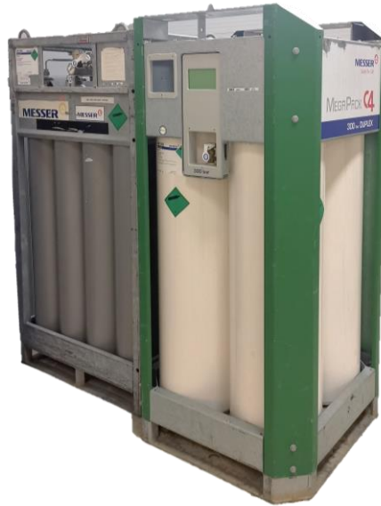
10. ábra Nitrogén és argon védőgáz bündeles rendszerben [saját]
