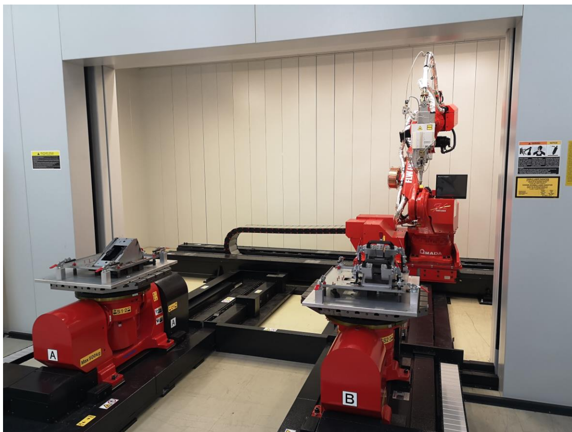
12. ábra A robotkar és a behordó asztalok egymáshoz viszonyított helyzete [saját]
