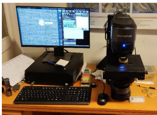
35.ábra. Olympus DSX10-BSW típusú mikroszkóp és szoftvere
