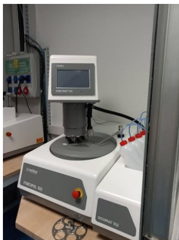
29.ábra. Csiszoló/polírozó gép (Metcon Forcipol 102) (bal), mikroszkóp (Olympus CKX53) (jobb)
