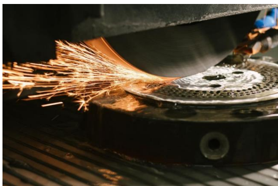
7.ábra. Granuláló fej (előlap) köszörülése [3]
