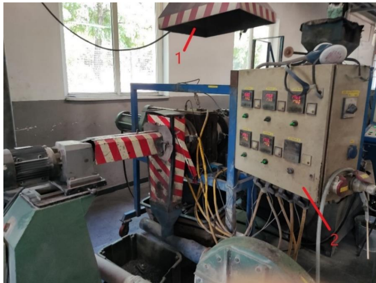
5.ábra. Gőzelvezetés (1) és hőmérsékletszabályozás (2)
