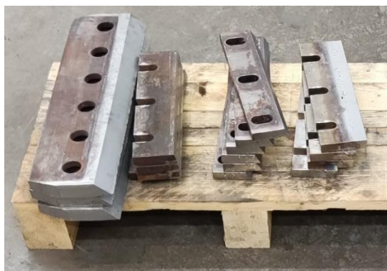
2.ábra. Granulátum levágása kétkéses szerszámmal (bal) [3], javításra váró kések (jobb)
