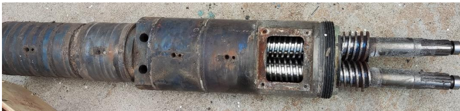
4.ábra. Kettős csigaház szellőzőfuratokkal
