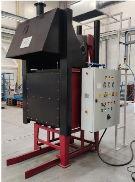
21.ábra. Muhel E/NV típusú nitrogén védőgázos megersztő kemence
