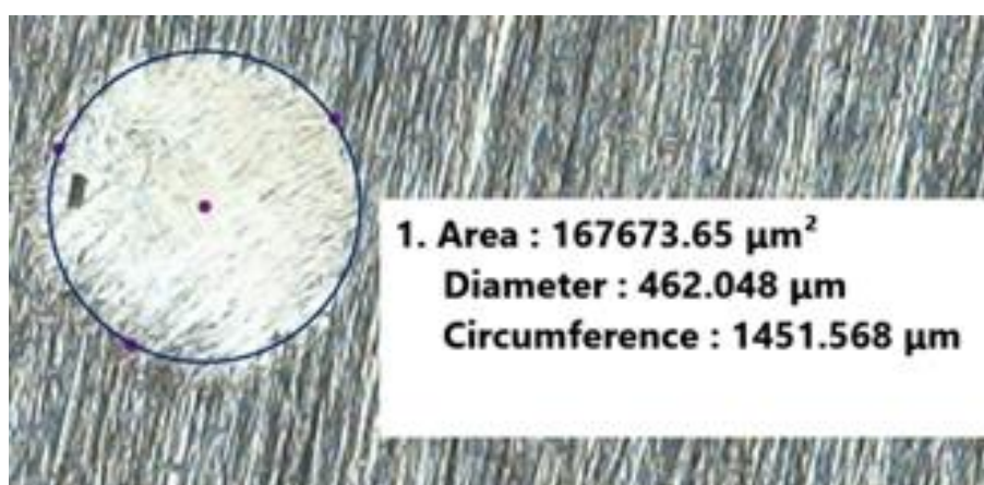
44.ábra. A harmadik minta 3. kopási képe
