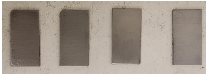
32.ábra. A koptatóvizsgálat próbatestei (jobb oldali kettő a mélyhűtött)
