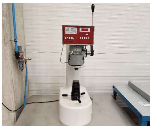
27.ábra. Ernst AT130 D típusú keménységmérő gép
