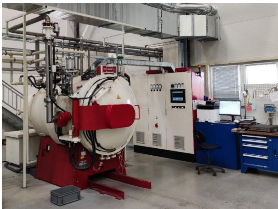
20.ábra. IU72/1F 2RV 60x60x40 10 bar CP Schmetz típusú vákuum kemence és szabályozó berendezése
