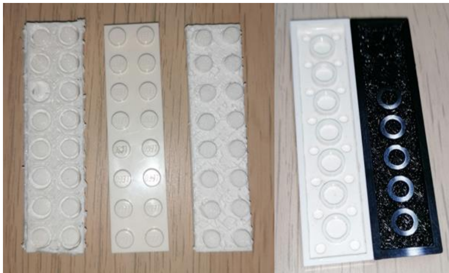
36. ábra Elcsúszott rétegek (bal), és "elefántláb" hiba (jobb) [saját]
