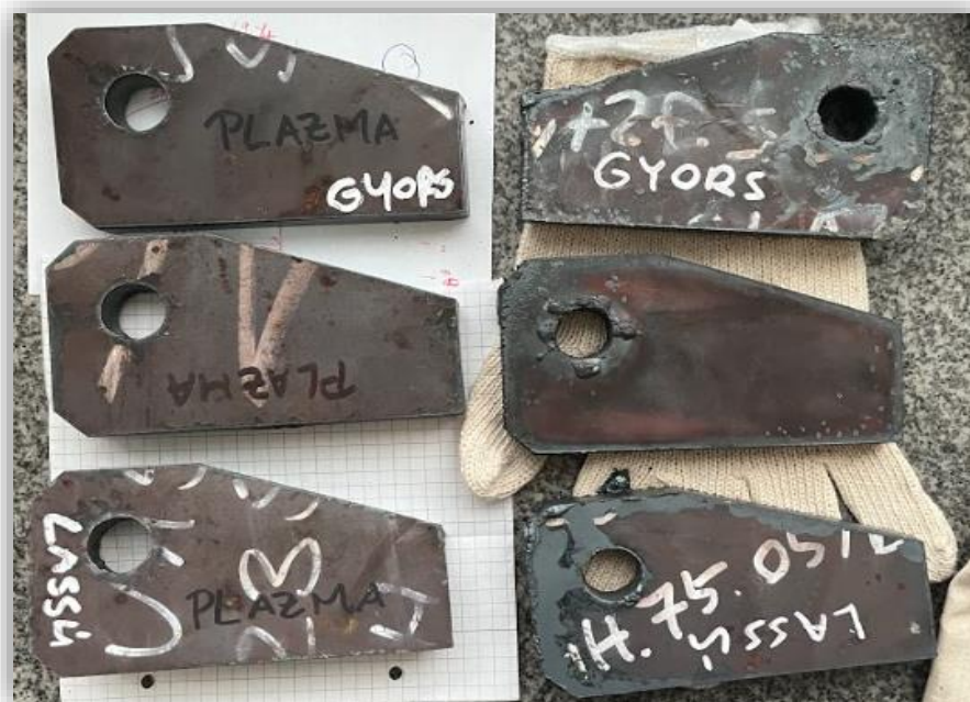
33. Első oszlopban a plazmavágási, második oszlopban pedig a lángvágási darabokat láthatjuk
