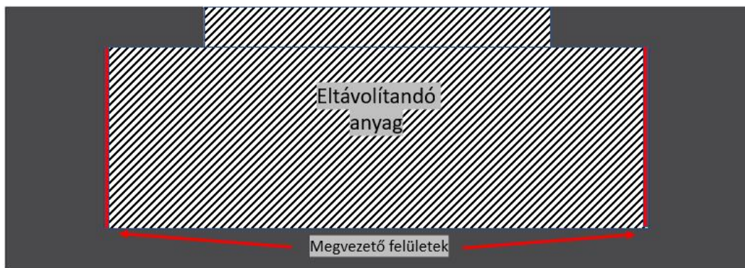
3.19. ábra Tervezett sínrendszer 1. verziója (saját)
