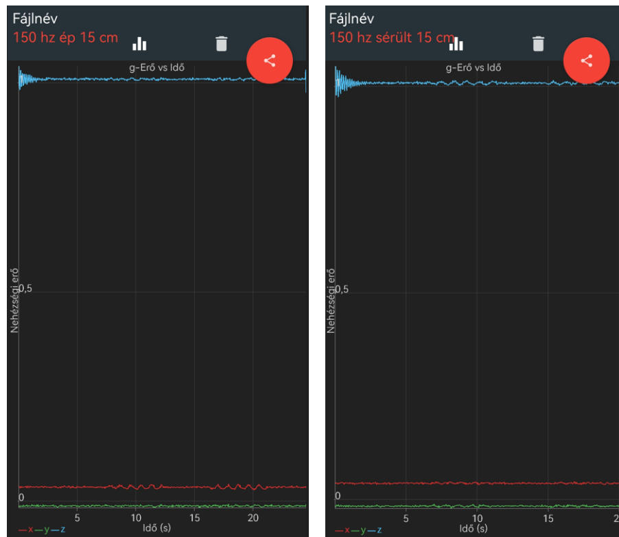
30. ábra: Ép lemez (bal) és sérült lemez (jobb) rezgésképe (Physics Toolbox)
