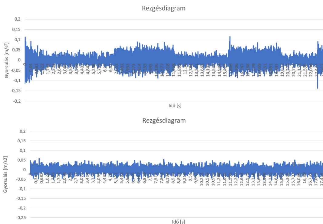
12. ábra: Ép lemez (felső) és sérült lemez (alsó) rezgésdiagramja a Z-tengelyen
